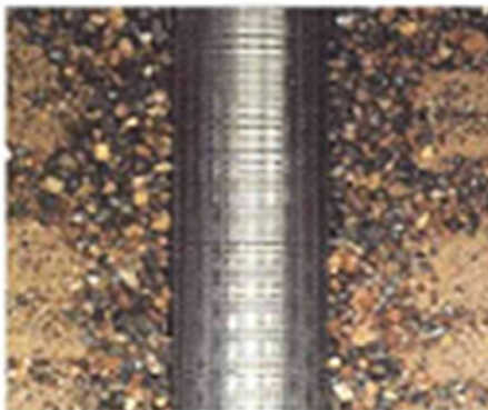
Corte mostrando el paquete de grava y la rejilla del pozo.
